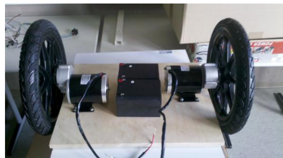
Der Prototyp – Die 500 W Antriebsmotoren mit Getriebeeinheiten und montierten Rädern
